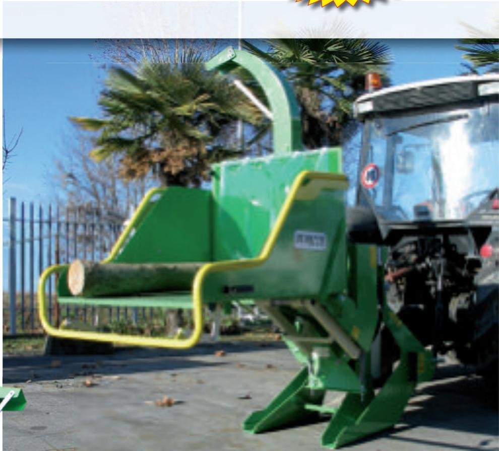
Dispositivo di regolazione avanzamento rullo idraulico per calibratura del cippato e mantenimento potenza disponibile.
